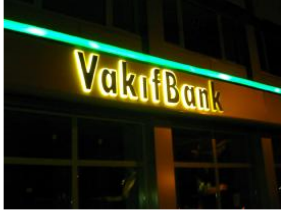
Resim 4.3: Floresan lamba ile yapılmış reklam aydınlatılması
