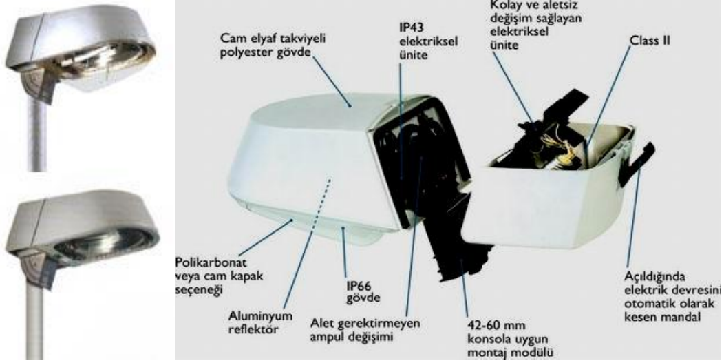
Resim 1.3: Otoyollar için yapılmış dış aydınlatma armatürleri
