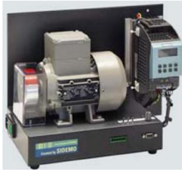
Resim 2.2: AC motor hız kontrol uygulaması
