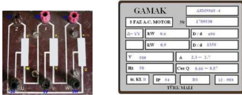
Resim 1.7: Eğitim amaçlı kullanılan seri üçgen dahlander motor klemensi ve etiket değerleri
