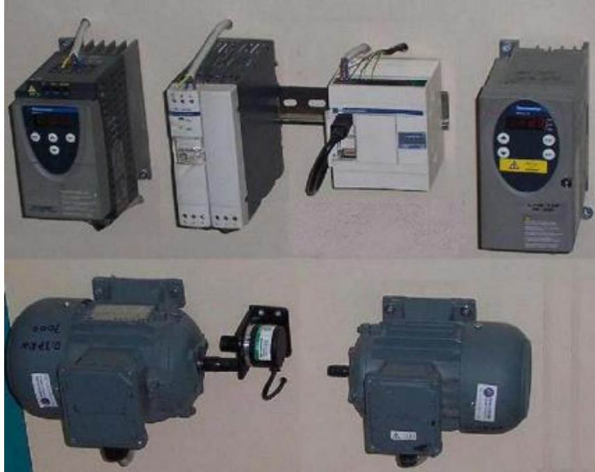
Resim 2.4: AC motor hız kontrol uygulaması
