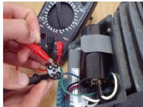
Resim 1.31: Bir fazlı motor sargı kontrolü
