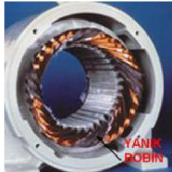
Resim 1.29: Yanmış stator sargıları
