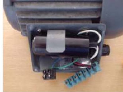
Resim 2.2: 1~ motora bağlanmış kondansatör
