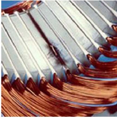
Resim 1.7: Oyuk içinden gövdeye kaçak
