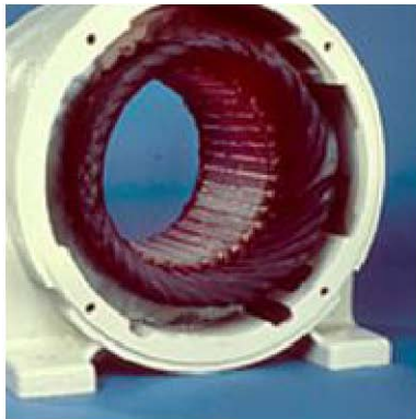
Resim 1.20: Aşırı akım sonucu yanan stator
