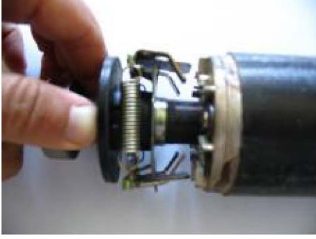
Resim 3.1: Merkezkaç anahtar hareketli parça
