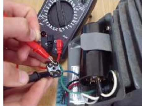
Resim 1.13: Bir fazlı motor sargı kontrolü
