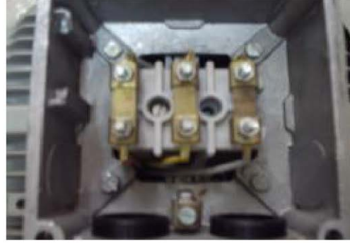
Resim 1.6: Üçgen bağlı motor klemensi
