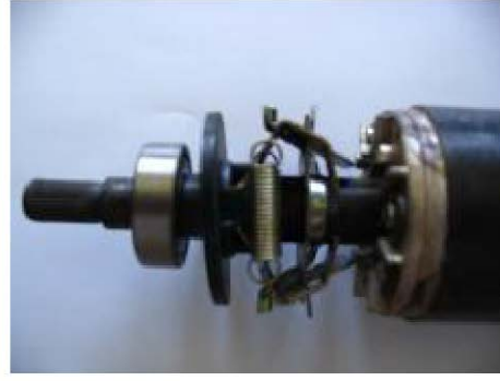
Resim 1.15: Kapağa montajlı merkezkaç anahtarı Resim 1.16: Rotor üzerindeki hareketli parça
