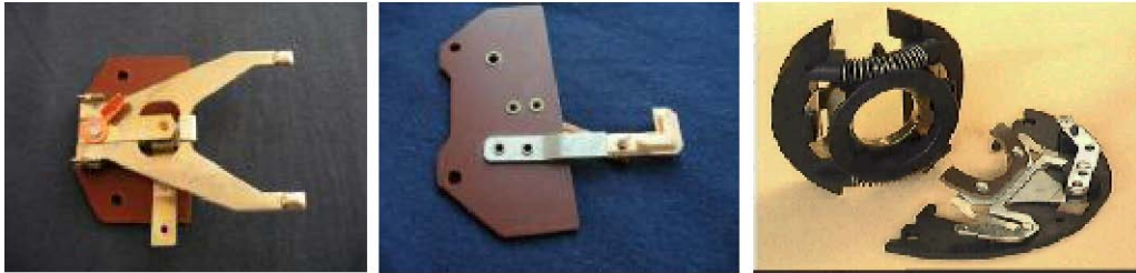
Resim 3.6: Merkezkaç anahtarında kullanılan çeşitli kontak yapı tipleri
