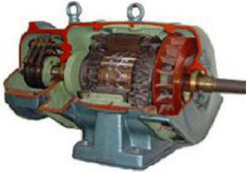
Resim 1.4: Sargılı rotorlu ( bilezikli ) asenkron motor
