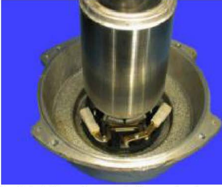
Resim 1.15: Kapağa montajlı merkezkaç anahtarı Resim 1.16: Rotor üzerindeki hareketli parça
